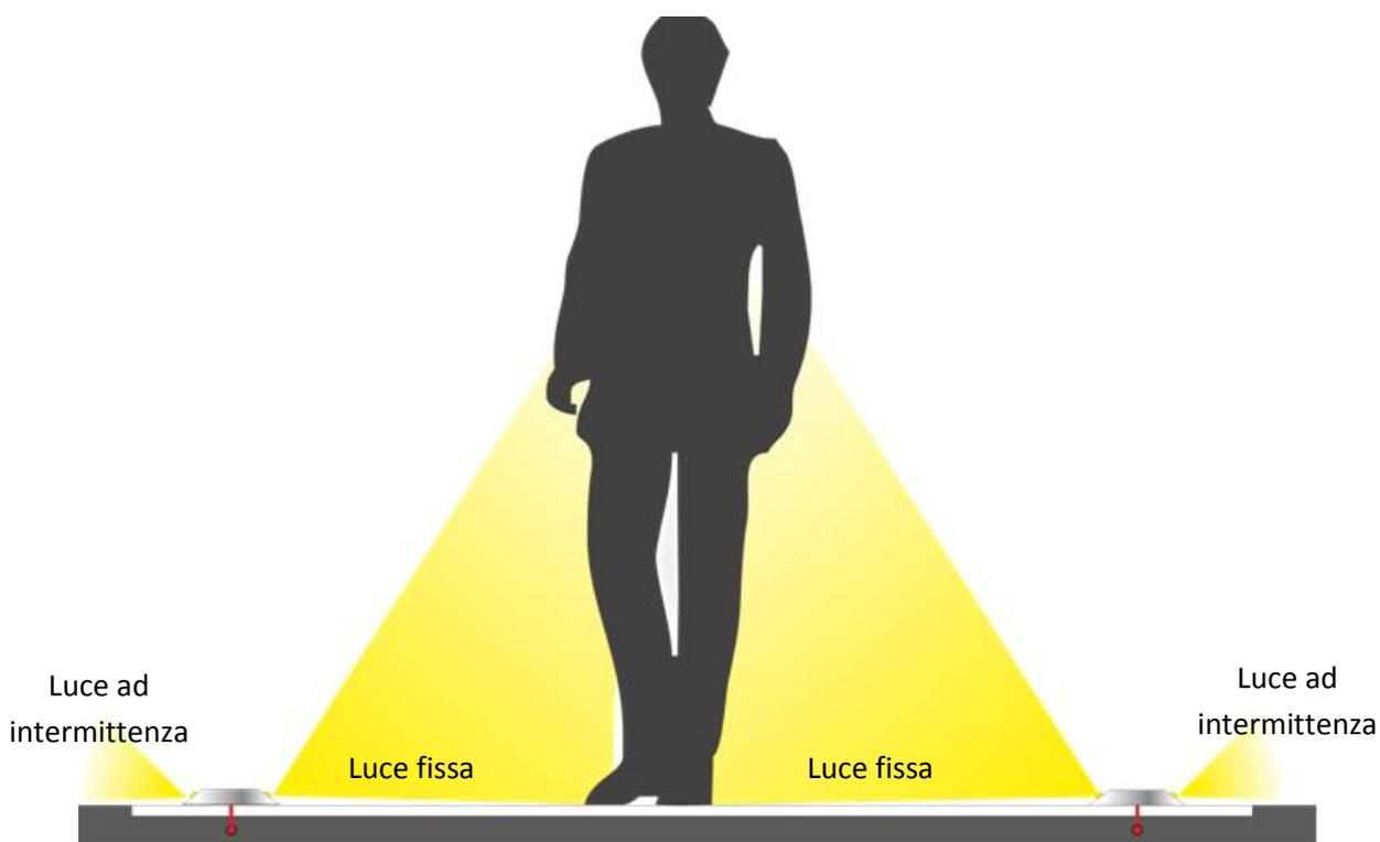
**Figura 2 Fasci luminosi dei marker nel sistema SMW**
